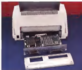
L'elettronica si altera ritoccando il filo della stampante: sulla destra è presente un processore M68020 ed i chip contengono il PostScript
